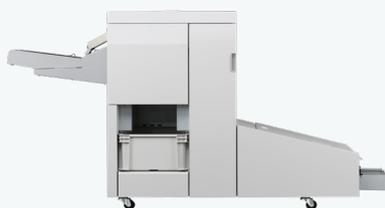
Erzeugt nach dem Sattelstichfinishing perfekt beschnittene Broschüren. Dies beseitigt den Bundzuwachs: Die inneren Seiten im Falz treten weiter nach außen als die äußeren. Deshalb werden alle durch einen Schnitt gleichzeitig auf Maß gebracht. Beschnittbreite: 2 bis 20 mm Beschnitt­höhe: bis 50 Blatt (einschließlich Umschlag) Grammatu­ren: 60 bis 300 g/m<sup>2</sup>
